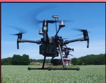
DJI M210 mit hochauflösender RGB- und Multispektralkamera
